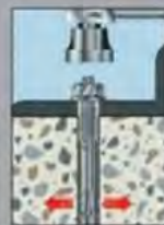
4. Serrare mediante chiave dinamometrica applicando la coppia di serraggio prescritta
