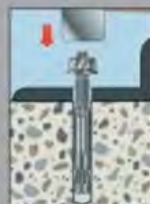
3. Implementare l'ancorante nel foro attraverso l'oggetto da fissare
