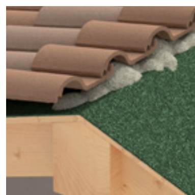
CASO 4 Posa diretta sull'estradosso del solaio e fissaggio a schiuma.
